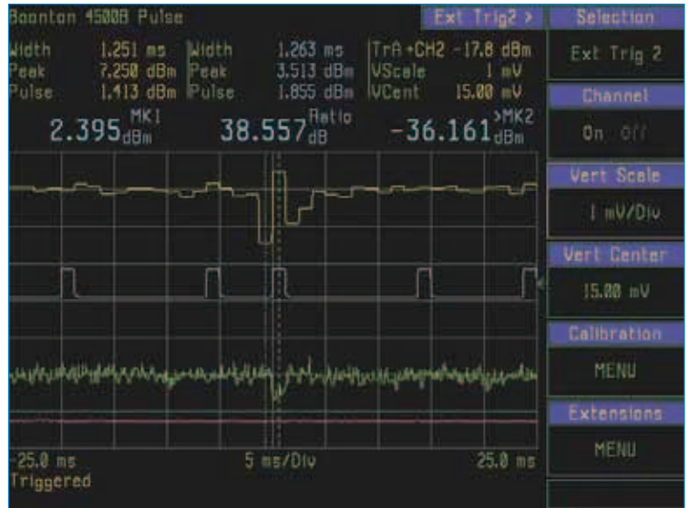
Рис. 1. Анализ последовательности импульсов CDMA с ВЧ-каналом и каналом запуска, обновляемыми одновременно
